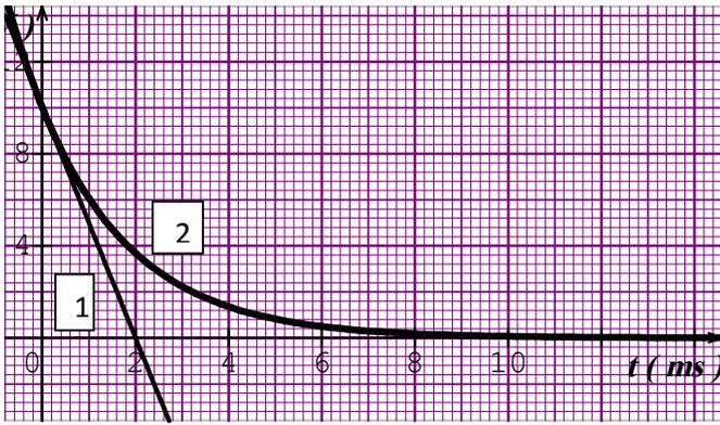
**2- تطور شدة التيار الكهربائي نحو قيمة ثابتة معدومة :**
